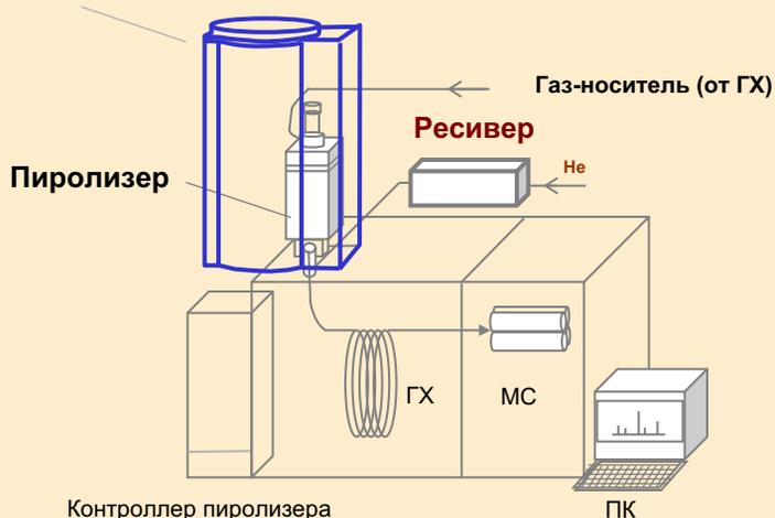
**Стандартная конфигурация ГХМС с пиролитической приставкой EGA/PY-3030 и автоподатчиком проб AS-1020E**
